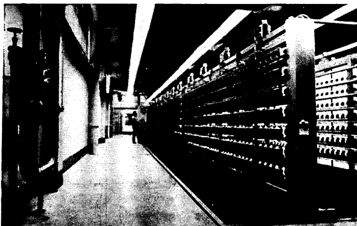
En estos modernos y estilizados equipos se realiza la urdimbre del hilado elastomérico.
