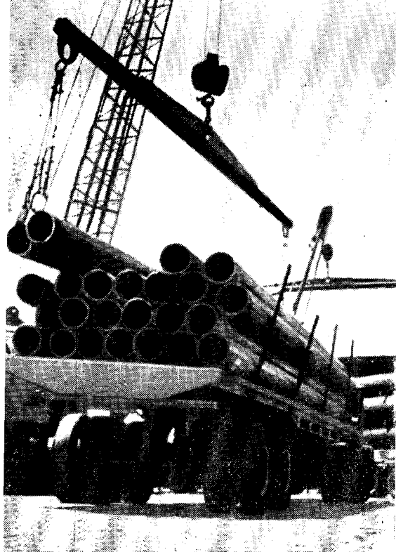
Caños de 813 mm. de diámetro producidos por la División Siat.
