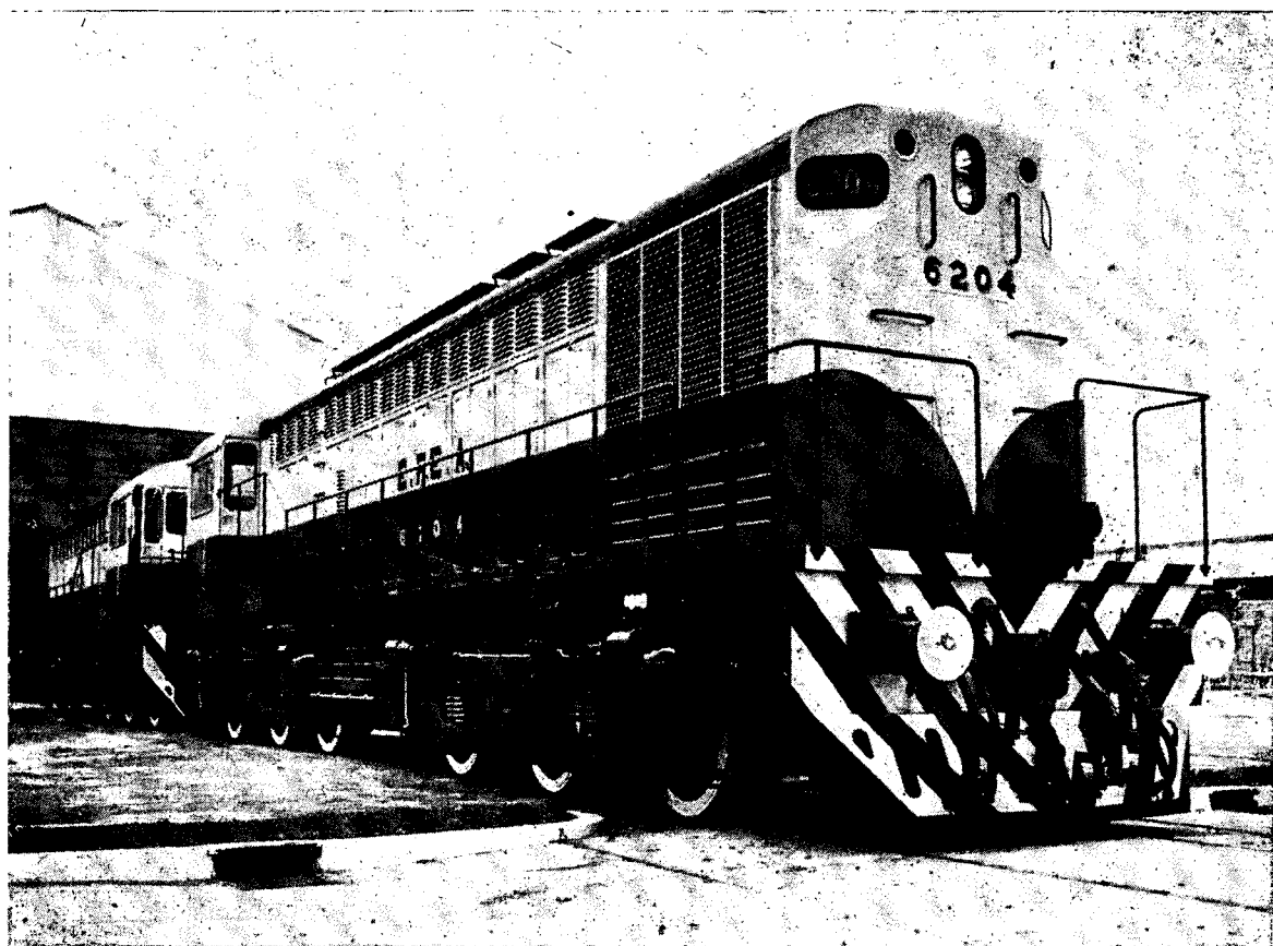
Locomotora Diesel Eléctrica de 1.050 CV. y 1.350 CV. de potencia, fabricada por G.A.I.A. Cometarsa, para trocha de 1.676 milímetros.
