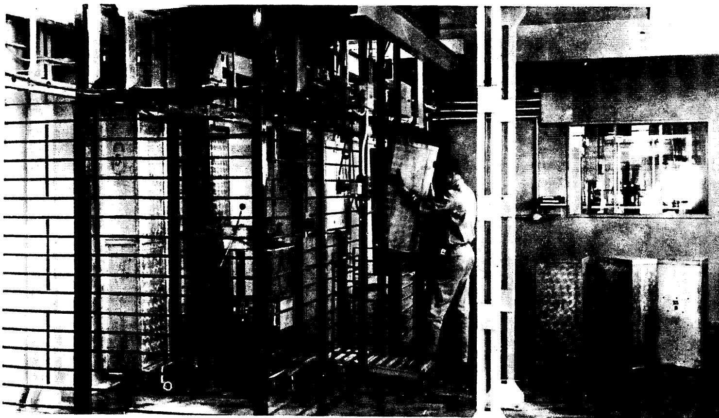
Un operario introduce muestras para ser tratadas en la Planta de Irradiación Semiindustrial del Centro Atómico Ezeiza, en las "jaulas" que luego circulan automáticamente a lo largo del "laberinto" blindado, hasta el recinto de irradiación.
